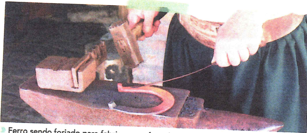
Ferro sendo forjado para fabricar uma ferradura.
